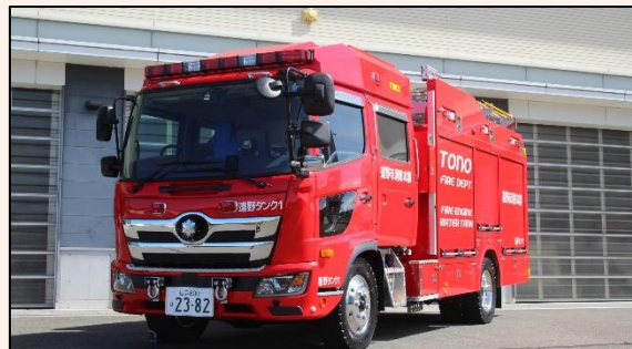
更新された水槽付ポンプ消防車
