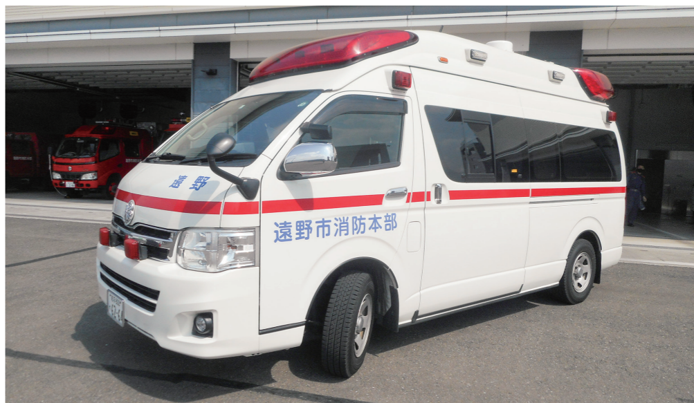
遠野消防署の高規格救急車 排気量が大きく室内で救急隊員が立ったまま処置ができる広さを有している
