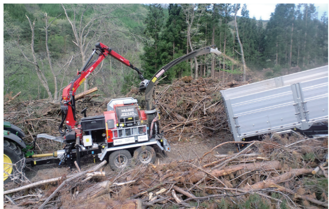
林地残材のチップ化作業の様子
