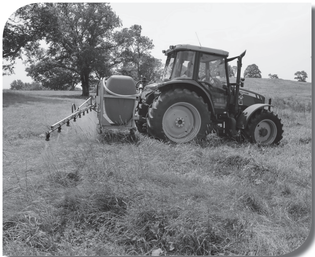
除染作業風景（除草剤散布）
