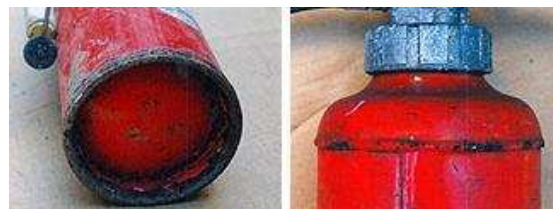
黒く変色している消火器
